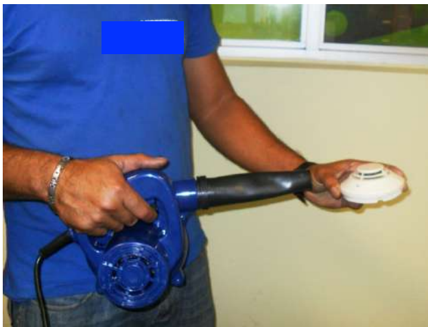
Foto #10: Mantenimiento a detector de humo fotoeléctrico del sub sistema de detección y alarmas de incendios de un sistema de extinción con agente limpio
