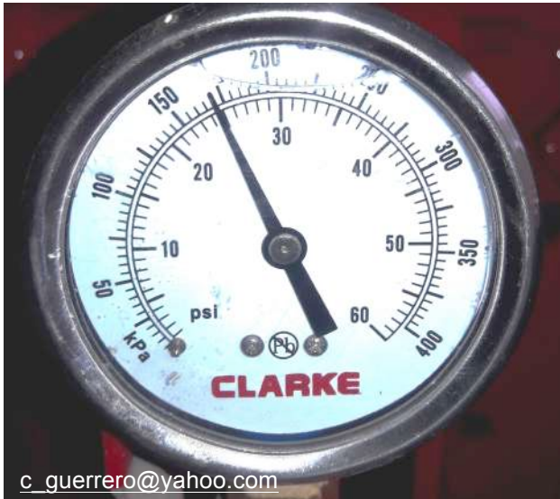
Foto #11: Inspección semanal de la presión de descarga de la bomba principal
