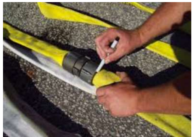
Foto #8: Mantenimiento anual a manguera contra incendios
