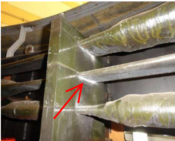
Fig. 5. Estator antiguo con evidencia de descargas parciales.
