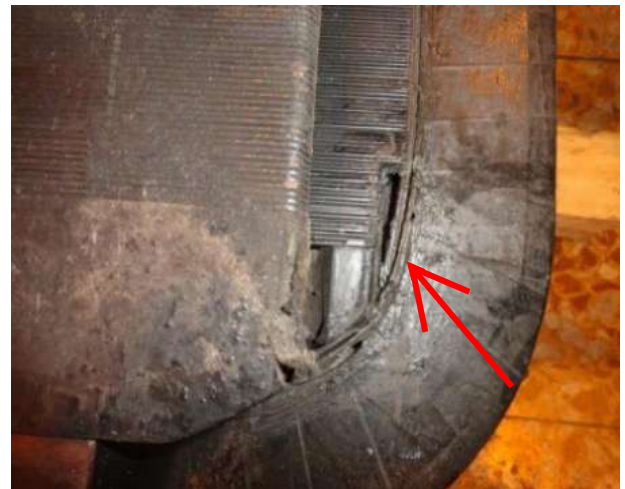
Fig. 6. Aislamiento en mal estado polos rotor.
