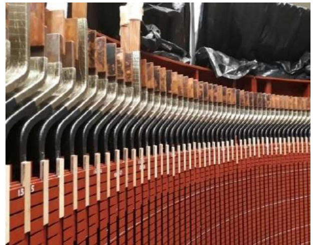
Fig. 11. Nuevo núcleo y devanado estator unidad 1.
