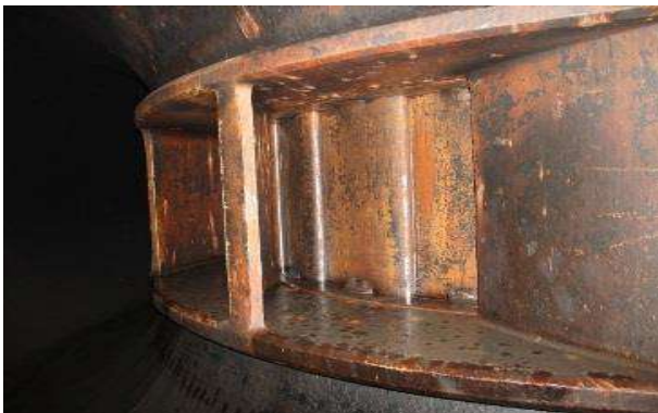
Fig. 10. Caracol y pre-distribuidor de la Unidad 1 de Salvajina con procesos químicos corrosivos.
