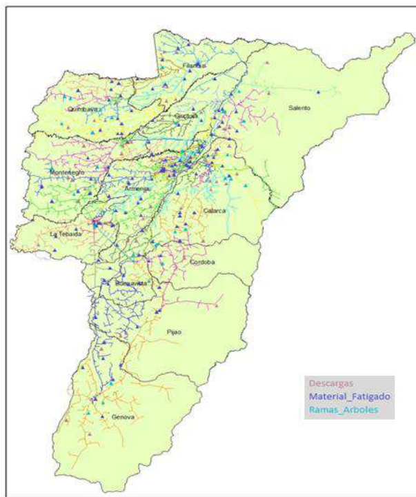
Figura 3. Mapa del SDL de EDEQ con los transformadores quemados por las causas de diagnóstico más sobresalientes
