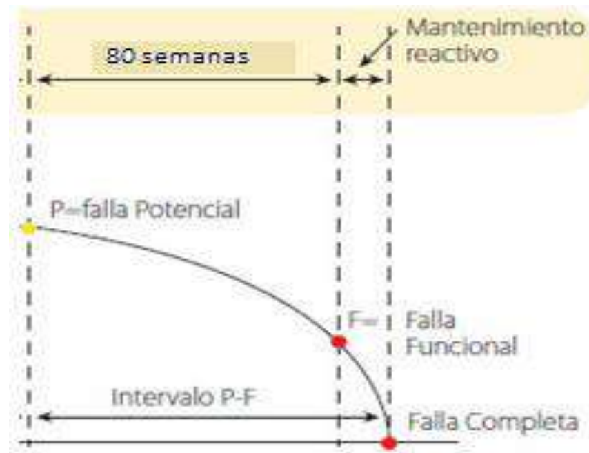
Figura 3. Curva P-F Equipo 1 para conexión floja detectada con termografía.
